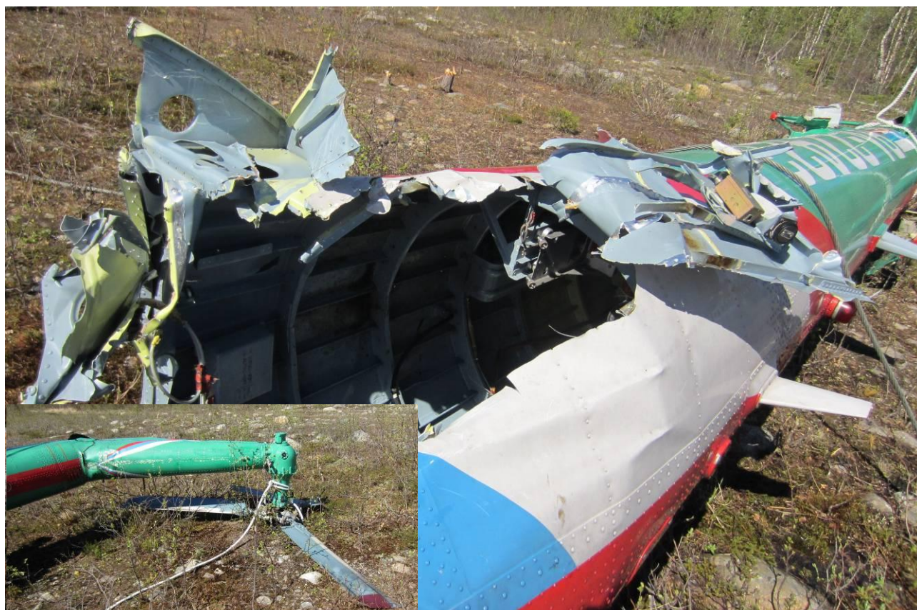
Рис. 4. Хвостовая балка с частью фюзеляжа
